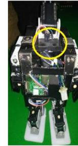
Gambar 4 Ilustrasi Peletakkan Sensor Tampak dari Belakang
