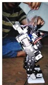
Gambar 8 Pengujian Robot Diam Gangguan Dorongan ke Depan dengan Masukan Nilai Secara Realtime
